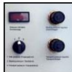
Separate Regelung für Strahl- und Transportdruck
